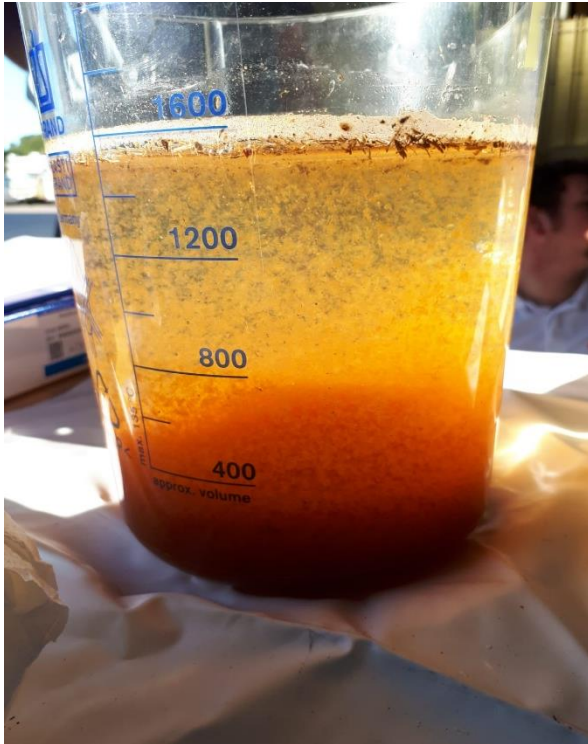
Rohwasser mit Eisen(III)-chlorid zur Flockenbildung
