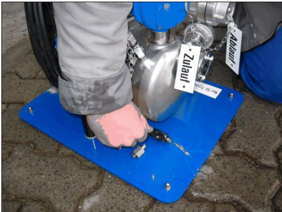
Abb. 36 Ablassen des Wassers aus Gehäuse
