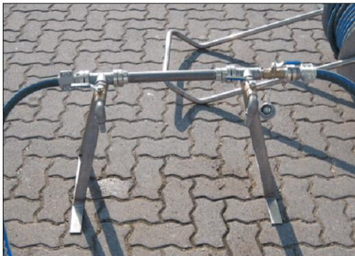
Abb. 13 Wasserabgabeverteiler
