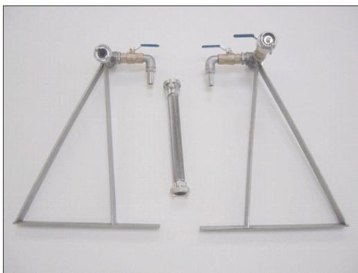
Abb. 3 Wasserabgabeverteiler
