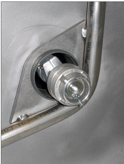
Abb. 17 Blindkupplung am 40 m Schlauch
