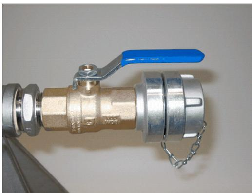
Abb. 14 Ausgang für Anschluß 10 m Schlauch
