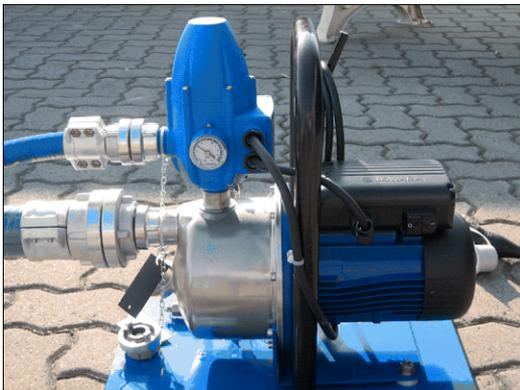
Abb. 34 Schlauchanschlüsse
