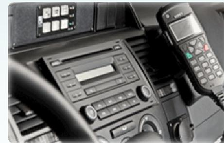
*Digitalfunk: Handbedienkonsole (HBC) der Firma Selectric*
