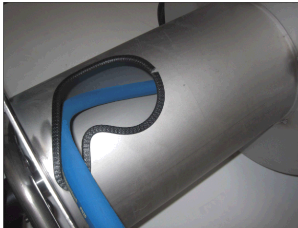
Abb. 3 Einlegen des Schlauches 40 m
