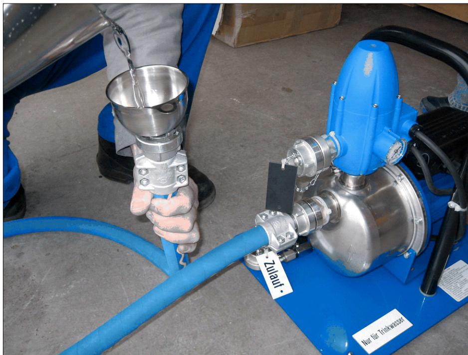
Abb. 4 Anfüllen des Pumpengehäuses
